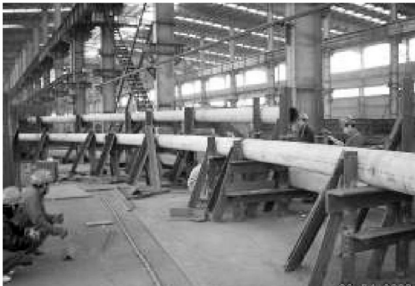
图6 弧形格构柱整体制作图
